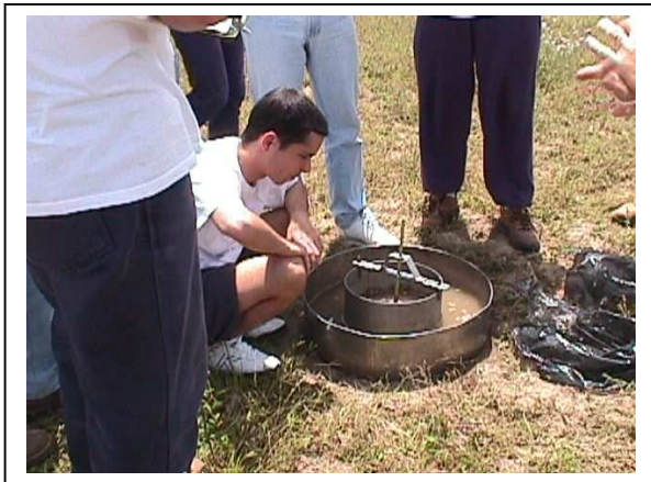
Foto 1 – ensaio dos cilindros concêntricos (para obtenção curva infiltração – fig. 3)
