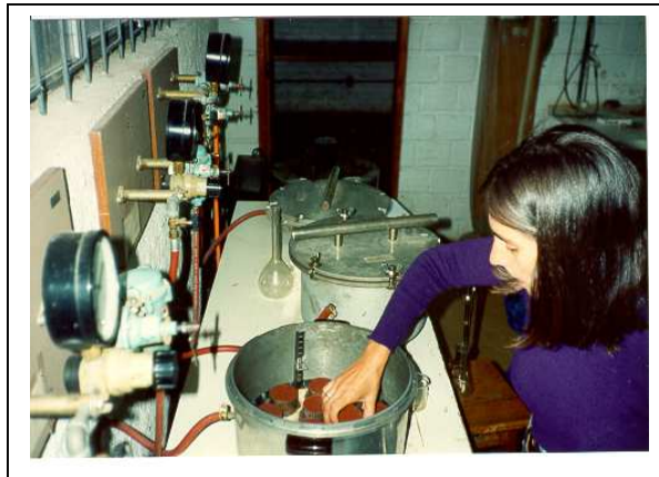
Foto 2 – Ensaio das placas de pressão (para obtenção curva armazenamento – fig. 4)
